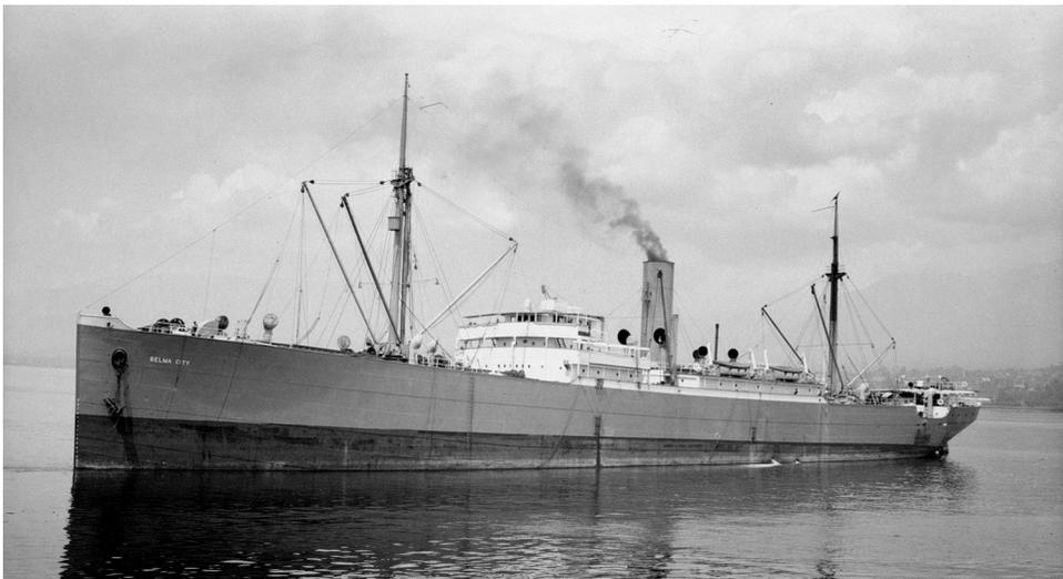
**Der Öltanker S.S. Selma war eines von 24 Stahlbetonschiffen, das 1918 im Rahmen des Emergency-Fleet-Programms in den USA gebaut wurde. Der Rumpf bestand aus Leichtbeton. Heute dient er als Wellenbrecher vor der Küste Galvestons, Texas. Der Betonrumpf ist nach fast 100 Jahren Salzwasser und Wellengang erstaunlich gut erhalten. (35.5)**
